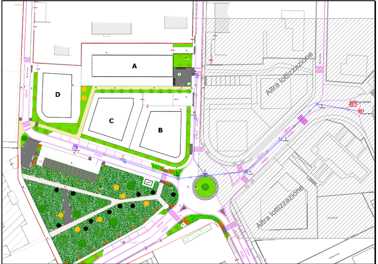
Figura 4: Disegno in pianta delle future lottizzazioni con indicati i tratti di fognatura nera.
